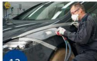
**13** Anschleifen für Füllerauftrag
