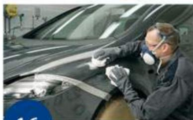
**16** Reinigen der Oberfläche
